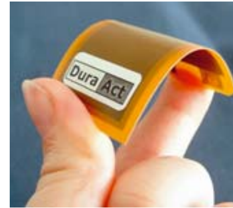
Ein Novum: Der markteingeführte Piezo-Wandler DuraAct lässt sich biegen und verkleben Bild: Invent
