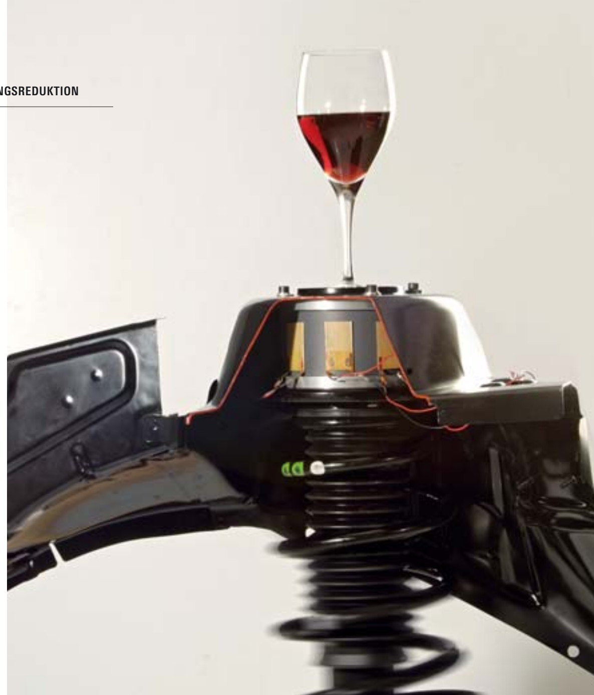
So erklären Fachleute der Adaptronik ihre Technik: Sie stellen das Glas Wein auf einen Resonator und lassen es vibrieren. Schalten sie nun den Regler der aktiven Schwingungskompensation ein, dann beruhigt sich der Wein im Glas auf der Stelle Bild: LBF
